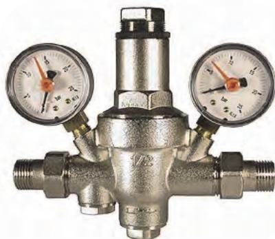
Riduttore di pressione con funzionamento a membrana, filtro in entrata, manometro ø 50 in entrata e in uscita. Attacchi con raccordo M.M. Pressione in uscita: 0,5 - 6 bar. Temperatura massima: 80°C. Nichelata.
