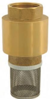
Valvola di fondo con otturatore in Nylon e guarnizione in NBR. Filtro Inox svitabile. E' caratterizzata da basse perdite di carico grazie al passaggio maggiorato.
