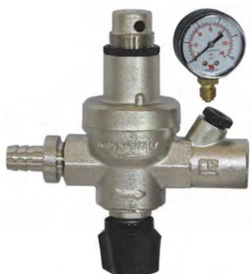
Gruppo di alimentazione automatico per impianti di riscaldamento a circuito chiuso, con filtro, valvola di non ritorno, rubinetto di arresto e portagomma. Pressione : PN 10 Pressione in uscita : 0,5 - 4 bar Temperatura max. di funzionamento : 80°C
