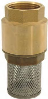
Valvola di fondo con otturatore in Nylon e guarnizione in NBR. Filtro Inox integrato nel corpo della valvola.
