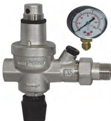
Gruppo di alimentazione automatico per impianti di riscaldamento a circuito chiuso, con filtro, valvola di non ritorno e rubinetto di arresto. Attacco F.M. Pressione max in : 10 bar Pressione in uscita : 0,5 - 4 bar Temperatura max. di funzionamento : 80°C Nichelato Manometro
