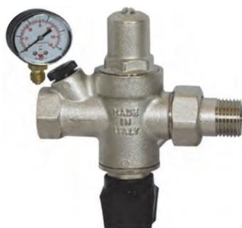
Gruppo di alimentazione automatico per impianti di riscaldamento a circuito chiuso, con filtro, valvola di non ritorno e rubinetto di arresto. Attacco M.F. Manometro Pressione : PN 10 Pressione in uscita : 1 - 4 bar Temperatura max. di funzionamento : 80°C
